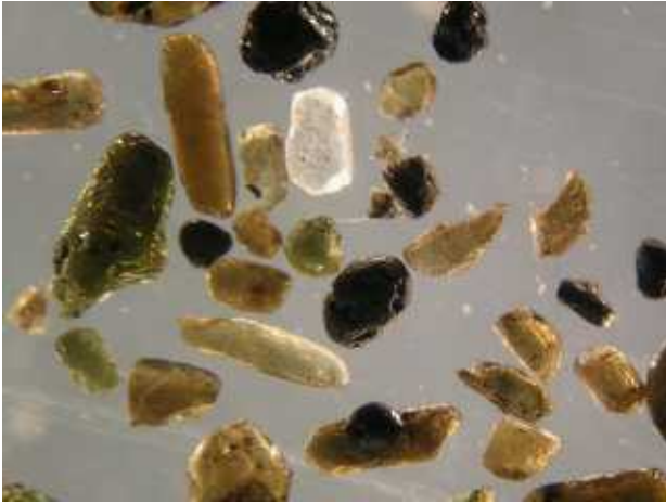
写真5：海岸砂をつくる鉱物。輝石2種（茶・緑）と斜長石（白）、磁鉄鉱（黒）。（鎌倉市七里ガ浜）
