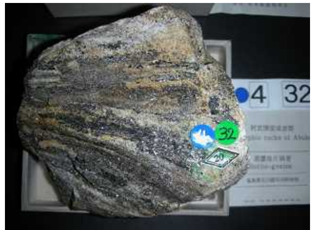
写真10：変成岩の一例。鉱物（黒雲母）の一定方向の配列がわかる。（黒雲母片麻岩）
